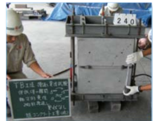
軸方向変位試験の状況 追従性を確認! はがれなし!
