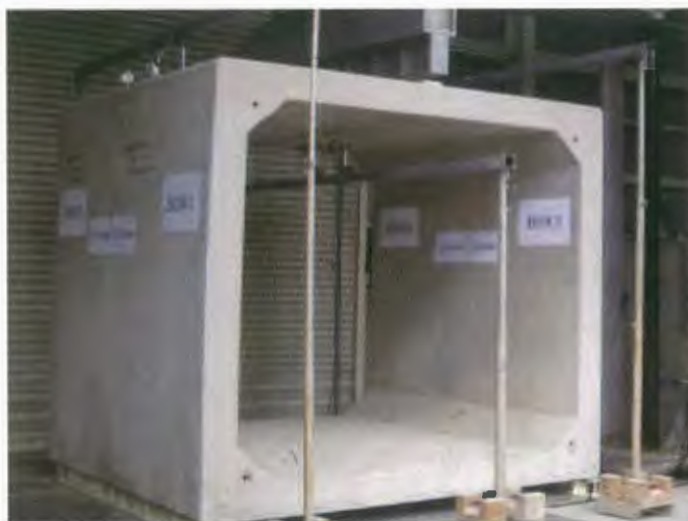
部材性能試験 (IB50R タイプ)
