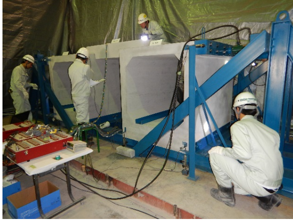
【実物大供試体による耐震性能確認試験】
