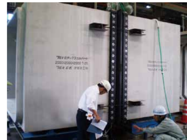
水密試験状況 (継手部の確認)
