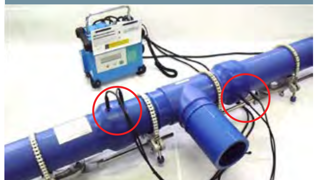
EF片受チーズ+EF片受直管 2 個同時通電
