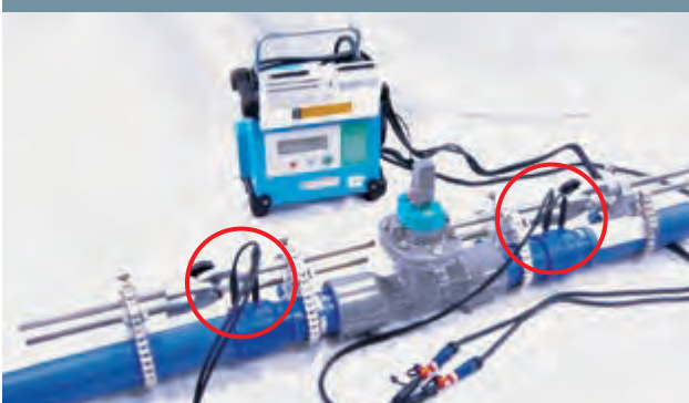
EF片受ソフトシール仕切弁+片受直管 2 個同時通電
