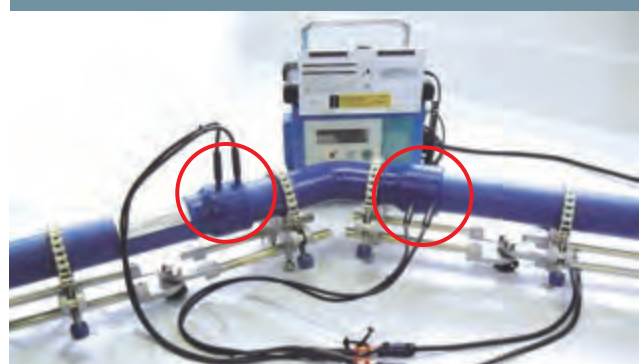
EF片受バンド+EF片受直管 2 個同時通電
