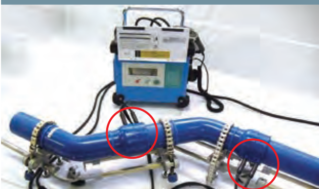
EF片受バンド+EF片受バンド 2 個同時通電
